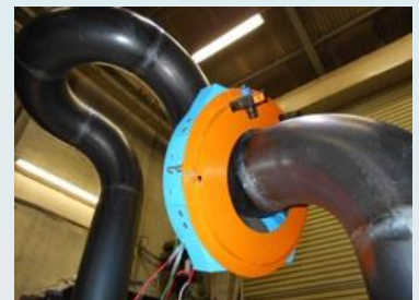
サーフ・エンジニアリング社の 配管検査ロボット
